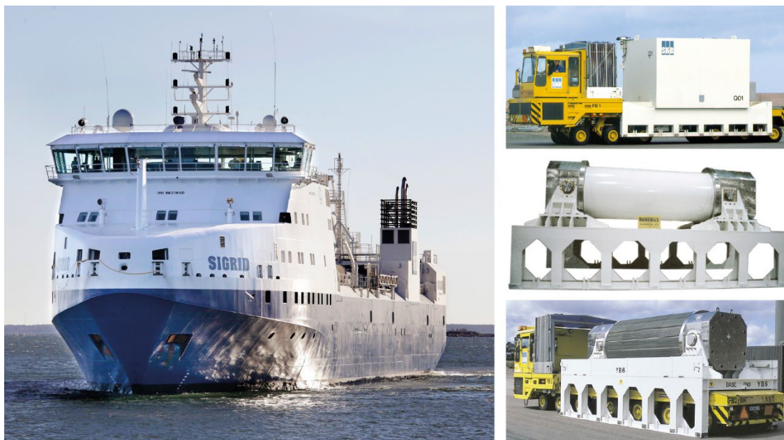
Figur 2-5. SKB:s transportsystem utgörs idag av ett fartyg, terminalfordon samt avfallstransportbehållare för kortlivat kärnavfall, behållare för hårdkomponenter och använt kärnbränsle.
